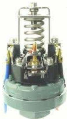
単極双投接点を備え、設定圧力の上限、下限において同時にON-OFFの2点制御信号が得られ必要に応じ設定圧力値の変更ができる圧力自動制御スイッチです。
